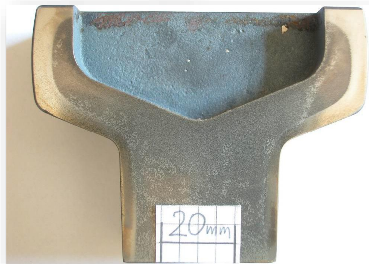
Rys. 9. Przykładowy kształt profilu zahartowanego
